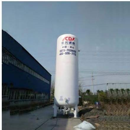
ГХК-3/2,5-100 (транспортный) - газификатор, выполненный на базе 6 сосудов DPW650-495-2,5. Применяется для хранения, транспортировки и газификации сжиженных продуктов разделения воздуха (кислород, азот, аргон, углекислота). Данное изделие относится к категории газификаторов холодных криогенных (ГХК). Другое название газификатора малого объема - криоцилиндр.
