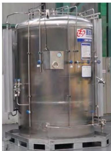
Технологическое удобство: в зависимости от геометрического объема, кислородный газификатор ГХК 3/1,75-200 способен заместить 405 стандартных 40-ка литровых баллонов. При эксплуатации газификатора нет необходимости в перевозке, разгрузке и погрузке громоздких и опасных баллонов. Достигается значительная экономия при транспортных затратах. Отсутствуют операции подключения и отключения баллонов в газовой рампе.
