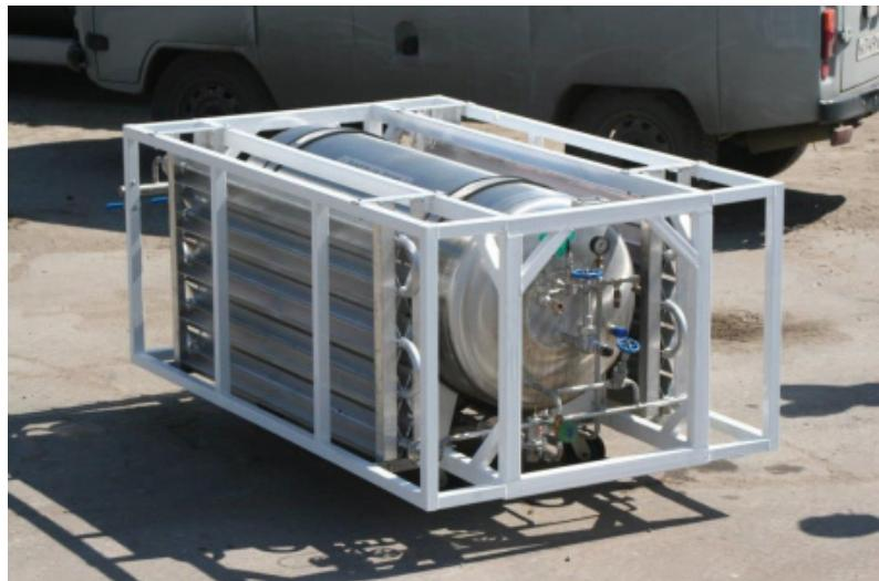
Газификатор ГХК 0,5/2,5-50 - газификатор, выполненный на базе сосуда DPW650-495-2,5. Применяется для хранения, транспортировки и газификации сжиженных продуктов разделения воздуха (кислород, азот, аргон, углекислота). Данное изделие относится к категории газификаторов холодных криогенных (ГХК). Другое название газификатора малого объема - криоцилиндр.
