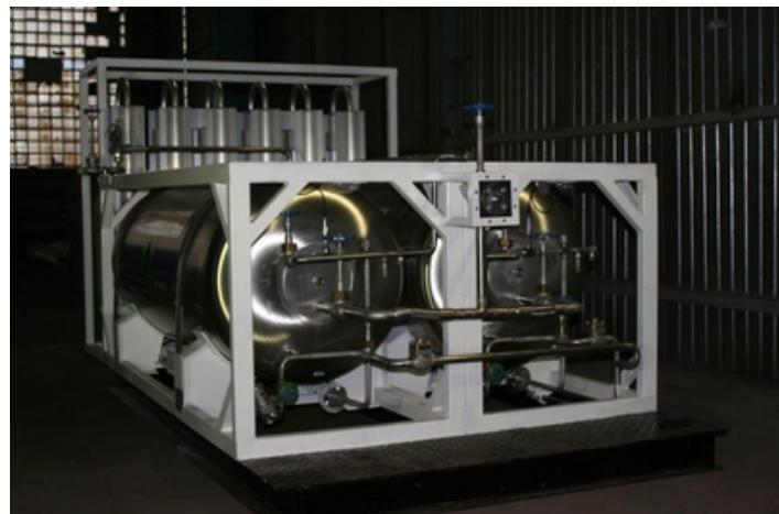
ГХК-1/2,5-50 - газификатор, выполненный на базе двух сосудов DPW650-495-2,5. Применяется для хранения, транспортировки и газификации сжиженных продуктов разделения воздуха (кислород, азот, аргон, углекислота). Данное изделие относится к категории газификаторов холодных криогенных (ГХК). Другое название газификатора малого объема - криоцилиндр.
