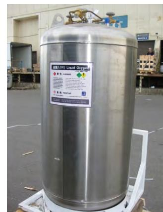
Регулятор давления, предназначенный для поддержания постоянного давления газовой подушки внутри сосуда, имеет функцию экономайзера, что исключает потерю полезного газообразного продукта, испаренного за время простоя. Избыточное давление газовой подушки через экономайзер переходит в линию потребителя.
