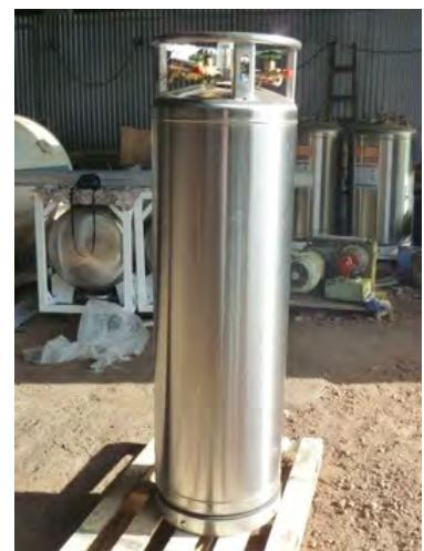
Гидравлическая емкость 210 литров, полезная емкость составляет 195 литров. Объем полезного газообразного продукта (по кислороду) составляет 170 нормальных кубических метра или 27 стандартных 40-литровых баллонов.
